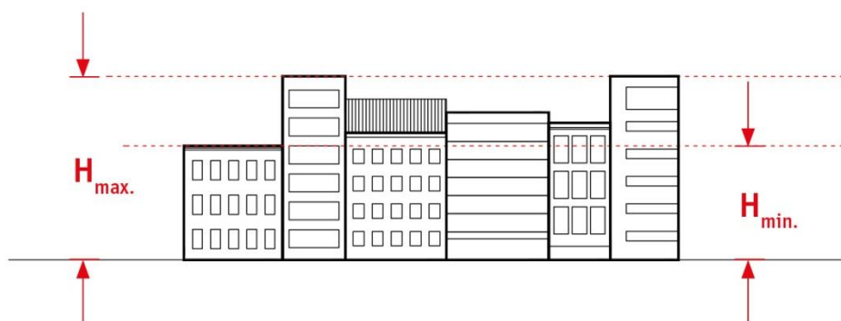
[ OBR. 21 ] Výšková hladina definuje limity maximální a minimální regulované výšky.
